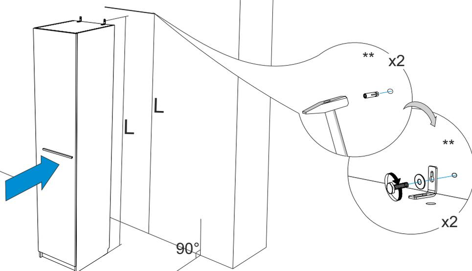
\*\* специализированный крепеж (выбирается в зависимости от материала стены)
