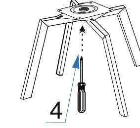
4. Убедитесь что все 4 ножки касаются поверхности и конструкция устойчива. Затяните центральный винт (4).
